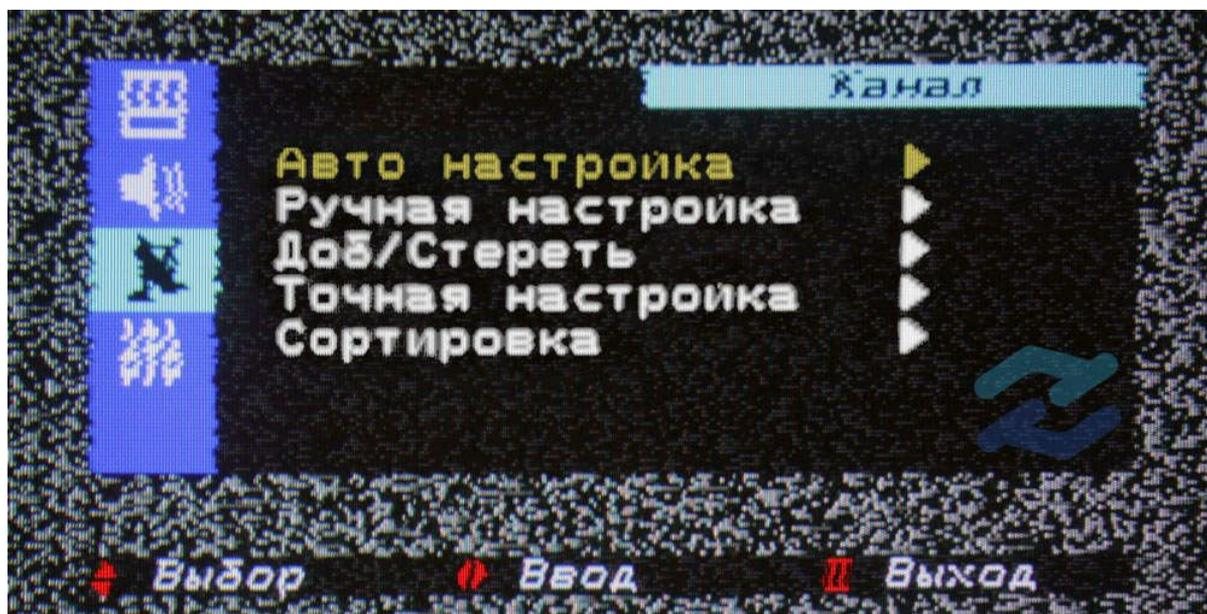
4. Чтобы запустить автонастройку достаточно еще раз нажать **кнопку со стрелочкой вправо**. Во время автоматического поиска на экране телевизора будет отображаться шкала прогресса. В течение всего времени сканирования каналов на экране на короткое время будут то появляться, то исчезать найденные каналы и меняться счетчик номера канала в углу экрана. Не прерывайте процесс настройки! Как только шкала достигнет 100% (полностью заполнится) процесс сканирования завершится.
