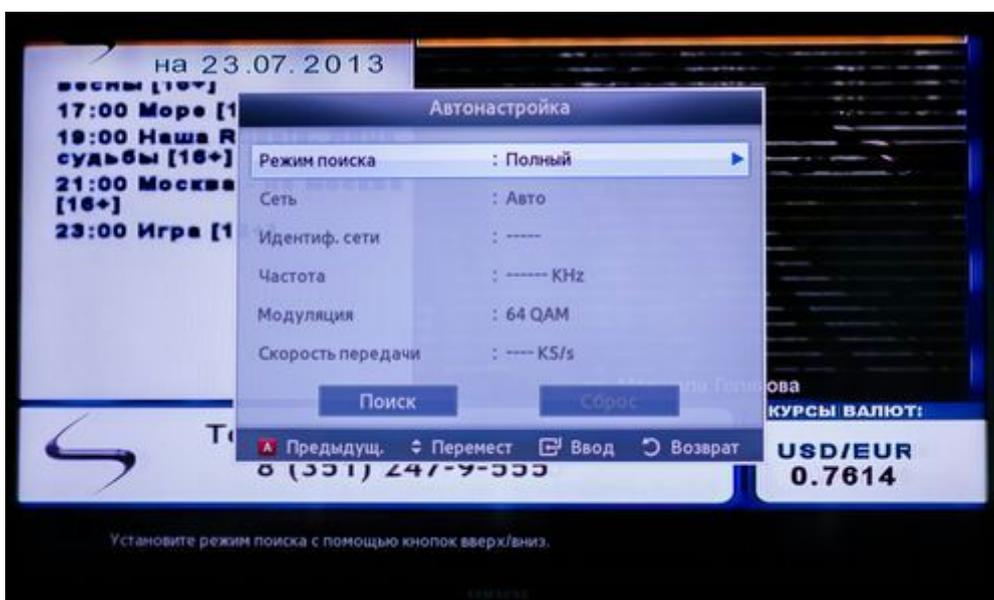
5. Запустится процесс автоматической настройки. Не прерывайте процесс настройки! Как только шкала достигнет 100% (полностью заполнится) процесс сканирования завершится.
