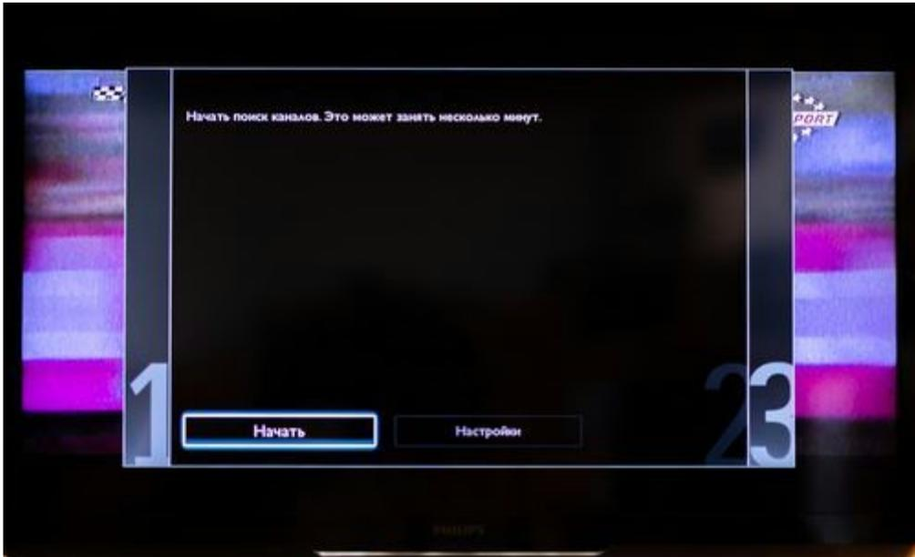
6. Запустится процесс поиска каналов. Не прерывайте процесс настройки! Как только шкала достигнет 100% (полностью заполнится) процесс сканирования завершится.
