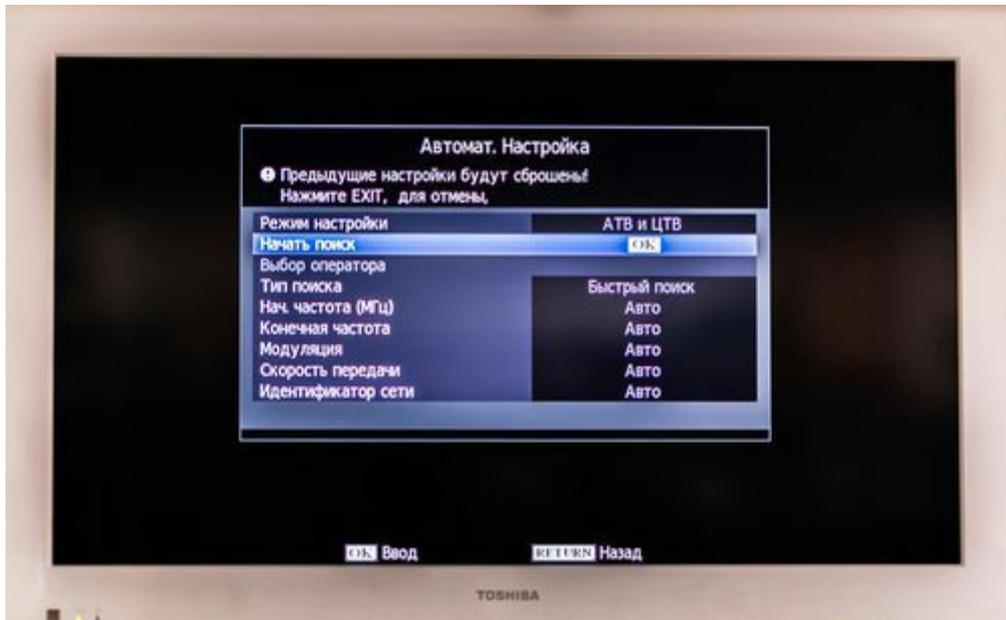
4. Запустится процесс автоматической настройки каналов. Не прерывайте процесс настройки! Как только шкала достигнет 100% (полностью заполнится) процесс сканирования завершится.
